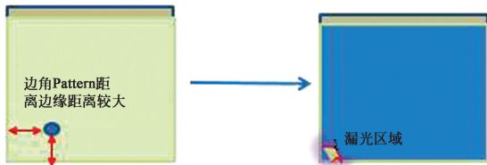
图 7 LC Pattern 影响边角漏光示意图
